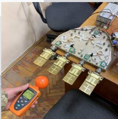
Вигляд розробленого макету імітатора АШЗ для РЛС сантиметрового і дециметрового діапазонів хвиль
