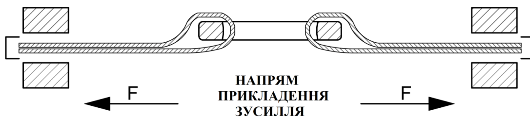
Рисунок 8 – Схема проведення випробування розривного навантаження рамки одноцілінної та півкільця
