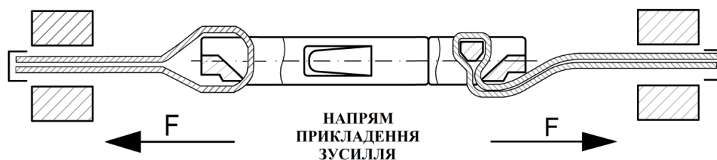
Рисунок 1 – Схема проведення випробування розривного навантаження фастексів Тип 1, Тип 3
