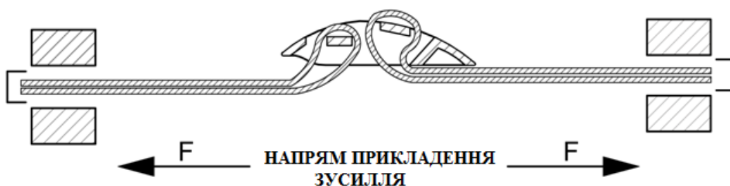
Рисунок 6 – Схема проведення випробування розривного навантаження пряжки-регулятора
