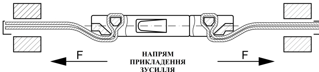
Рисунок 2 – Схема проведення випробування розривного навантаження фастексів Тип 2, Тип 4
